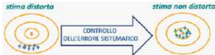
Fig. 4 – La distorsione della stima si riduce attraverso il controllo dell'errore sistematico (le croci rappresentano i valori delle stime campionarie, il centro del bersaglio rappresenta il valore vero nella popolazione).
