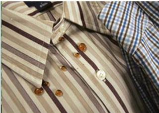
Nanoparticelle di sostanze organiche sono utilizzate per produrre tessuti **traspiranti**, ma perfettamente **impermeabili ed autopulenti**
