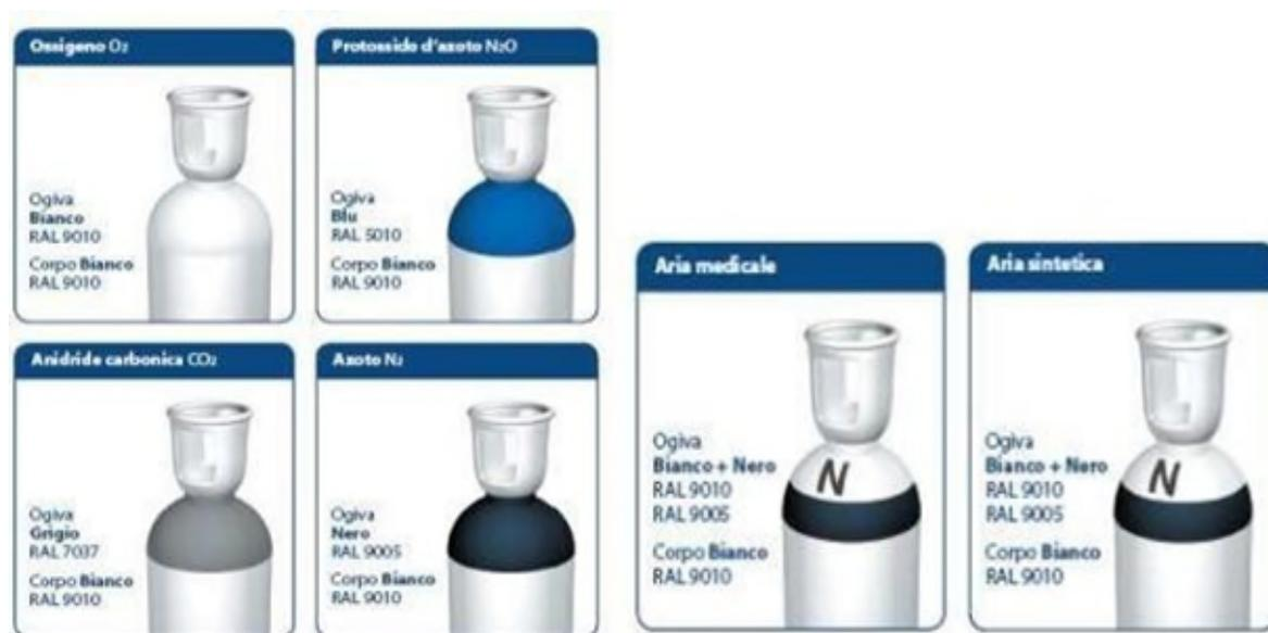
FIG. 3 *Classificazione della colorazione delle bombole contenenti gas medicinale*
