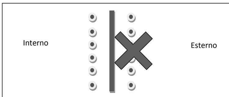
Esempio di posizionamento corretto della grata antintrusione
