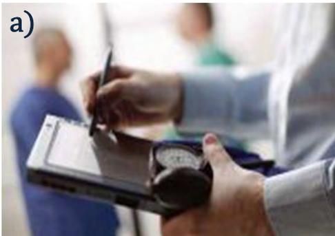
a) **Tablet o pc portatile** per il medico con lettore per riconoscere il paziente, dotato di monitor sensibile per la scrittura e di penna ottica.
