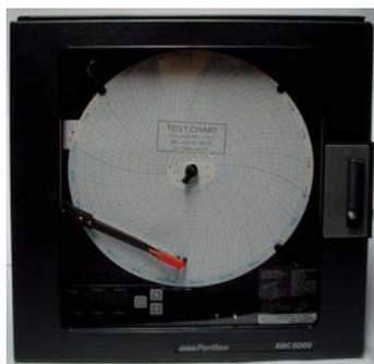
Sono disponibili modelli per diverse temperature e tempi di lavoro. Il registratore, collegato ad una sonda termica posta nel vano refrigerato è alimentato in modo autonomo e funziona anche in assenza di energia elettrica. Una volta calibrato, l'errore nelle registrazioni in genere non supera il  $\pm 2\%$ . I dischi vanno rinnovati ad ogni fine ciclo e possono essere conservati come documentazione di qualità di processo (GMP, GCP etc.)
